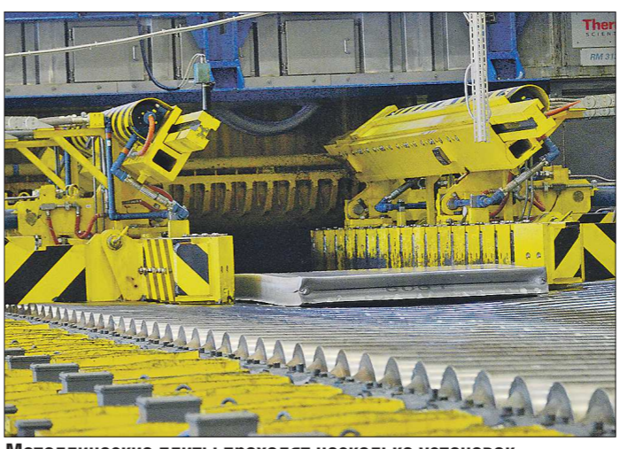
Металлические плиты проходят несколько установок, где им задаются форма и размер, необходимые заказчику
