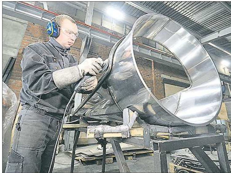
Стыки между металлическими деталями шлифуются вручную, чтобы избежать травматизма детей
