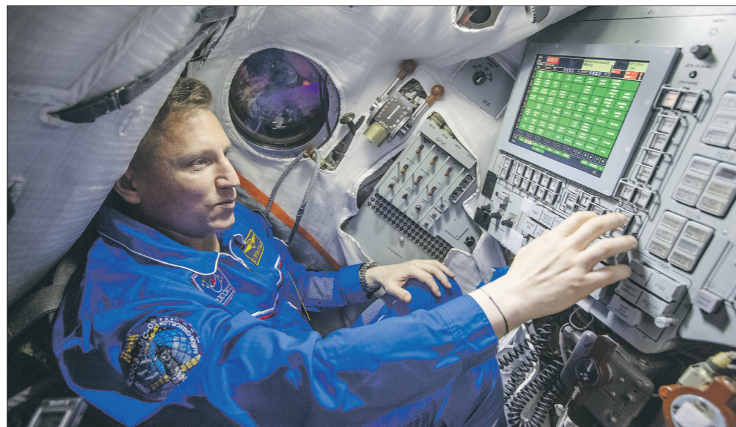
В корабле «Союз МС» все кнопки на панели управления отделены друг от друга металлическими перегородками, чтобы случайно не нажать соседнюю
