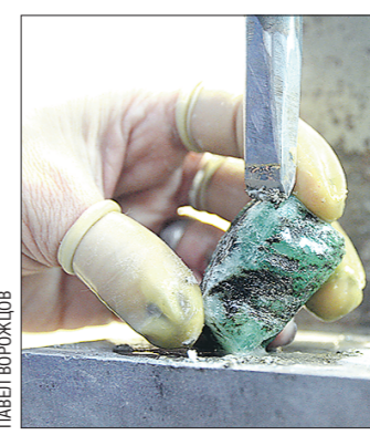
Для более качественной обработки изумрудов их механические очищают под прессом
