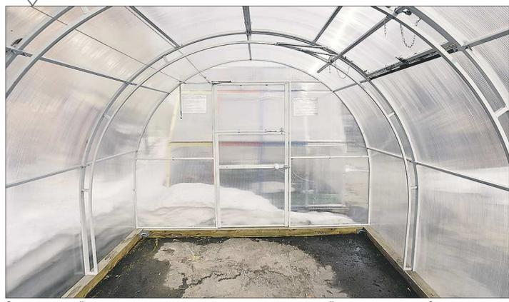
Арочная с двойными дугами, расположенными одна под другой — это один из наиболее прочных вариантов теплицы из металлических конструкций под сотовый поликарбонат. Такую теплицу часто называют фермерской. А есть и другие варианты металлических теплиц — в форме капельки, домиком, по Миттлайдеру...
