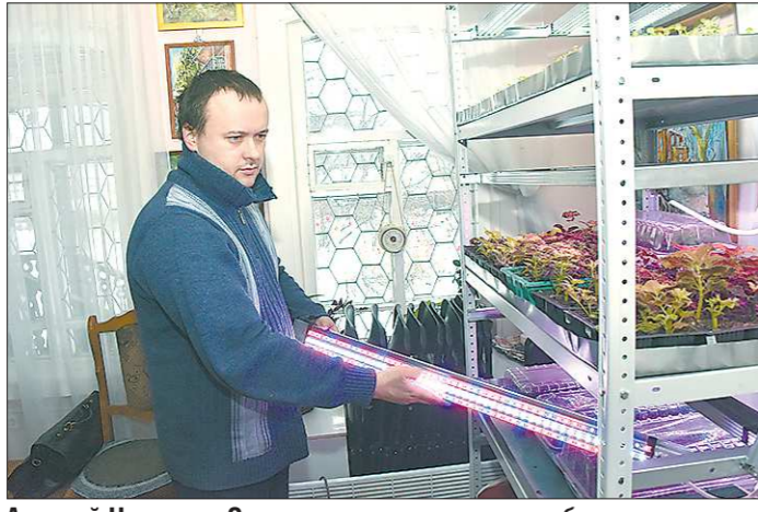
Алексей Никитин: «Светодиоды я прикрепил к обычному потолочному профилю для гипсокартона»
