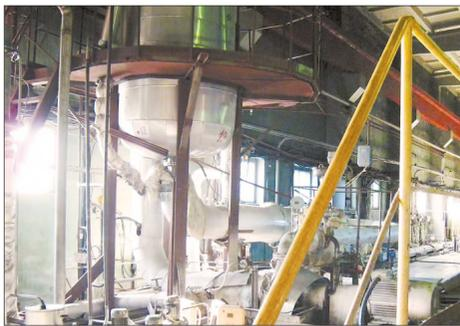
Такая установка для переработки жидких РАО производства СвердНИИХиммаша работает на БАЭС
