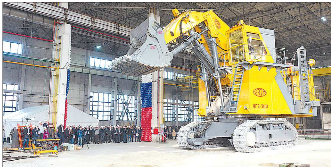
Масса экскаватора УГЭ-300 - 300 тонн, объём ковша - 16 кубических метров
