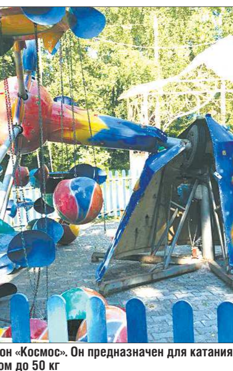
Рухнувший аттракцион «Космос». Он предназначен для катания детей до 15 лет, весом до 50 кг
