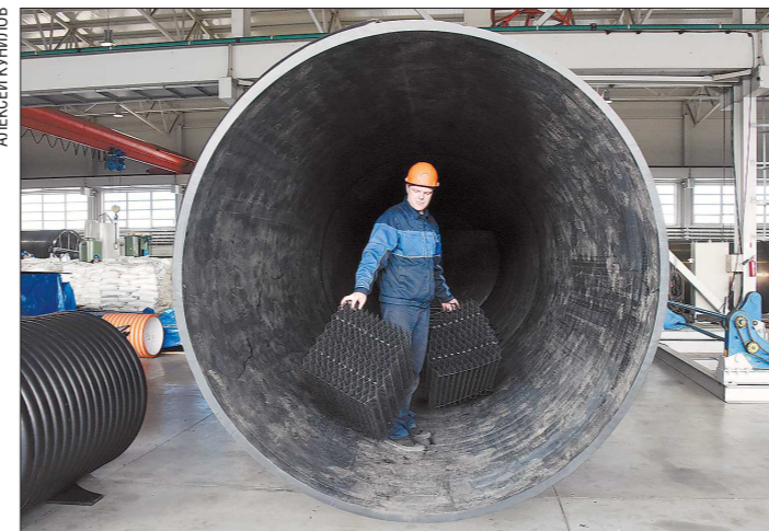
На заводе «Уником» инженеры познакомились с изготовлением полиэтиленовых резервуаров, заготовкой для которых служат ёмкости, где человек может передвигаться в полный рост
