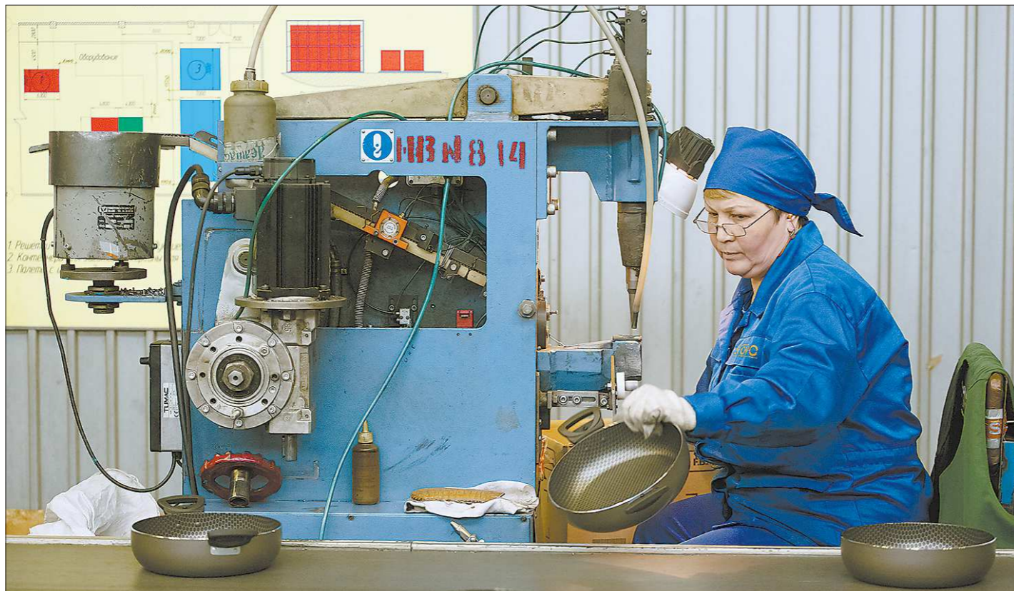
Путь сковородок по конвейеру после выхода с пресса недолог — остаётся лишь подравнять края и прикрепить к посуде ручки. Процедура занимает менее пяти минут
