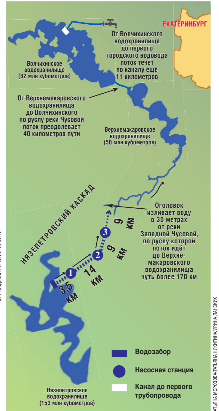
Для обеспечения города-миллионника водой создано три водохранилища: Волчихинское, Верхнемакаровское и Нязепетровское. Их общий объём составляет 285 миллионов кубометров
