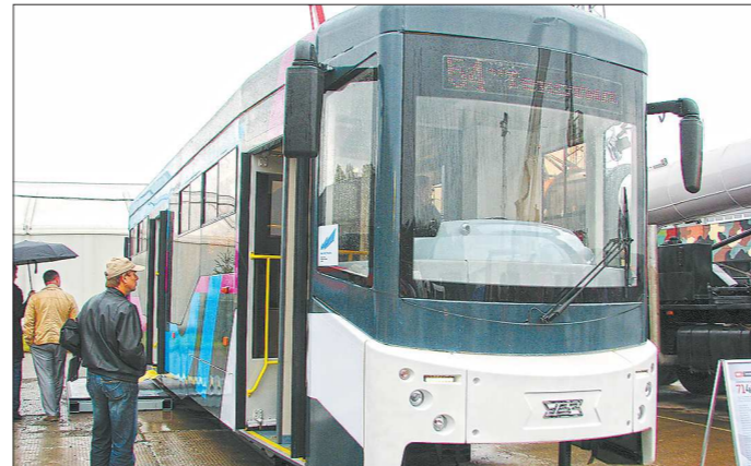
Уралтрансмаш известен не только самоходными гаубицами. В 2014-м гвоздём программы выставки на «Старателе» стал трамвайный вагон 71-407-01 с частично низким полом
