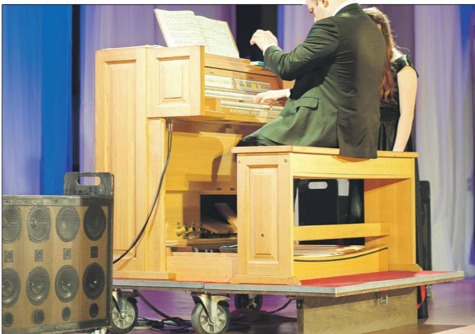
Как видите, игровой пульт цифрового органа ничем не отличается от пультов духовых органов. Но вместо труб к нему подключена компьютерная система, каждый звук с которой записан с тысяч труб настоящего органа
