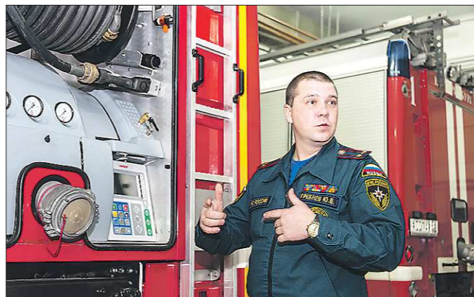
Юрий Гребнев рассказал, что новые автомобили МАН для тушения пожара оснащены системой электронного управления подачи воды
