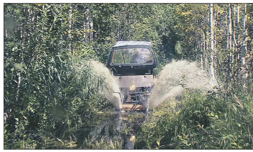
Жители посёлка Берёзовский ездят в магазин на самодельной дрезине: мотор — от мотоцикла «Минск», противветровое стекло — от «Оки», мелкие запчасти — от мотороллера
