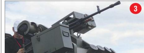
**3** **Дистанционно управляемый боевой комплекс «Арбалет-DM» на базе броневедомоля «Тигра». Разработчик и производитель — Ковровский электромеханический завод и компания «Оружейные мастерские».**
