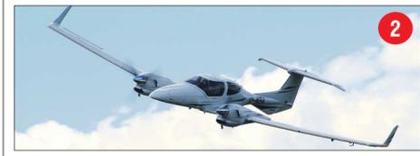
**2** **Комплекс воздушной разведки на базе лёгких самолётов «Даймонд DA-42». Разработчик и производитель — компания «РТИ Аэрокосмические системы» (АКС).**
