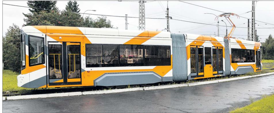
Новый трёхсекционный трамвай Уралтрансмаша имеет длину 21,9 метра и способен одновременно перевозить 205 пассажиров, то есть в два с лишним раза больше, чем наиболее распространённый сейчас на наших линиях чешский трамвай «Татра Т3» (95 человек)
