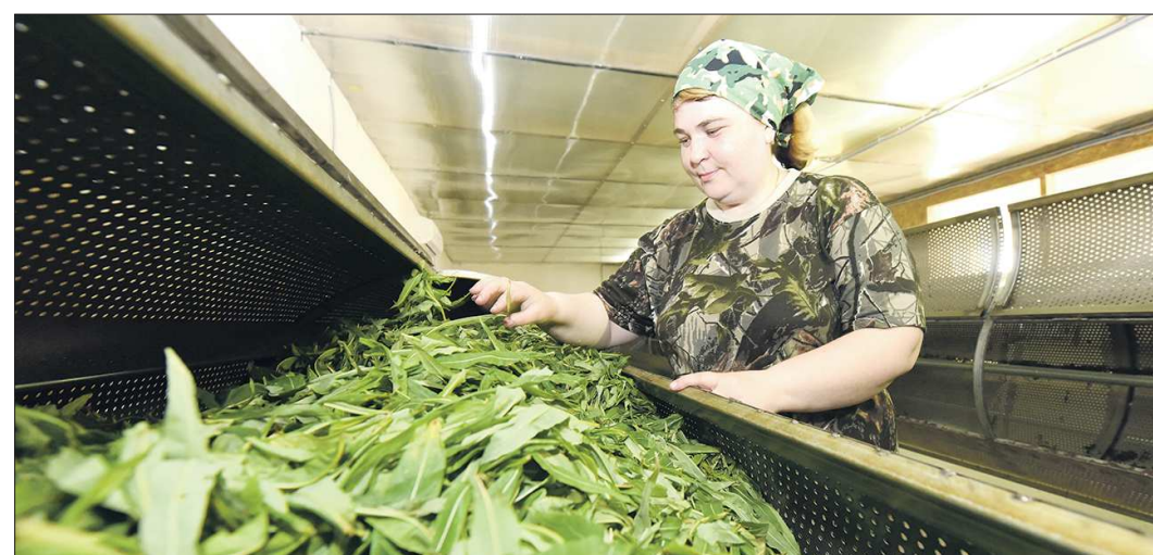
Первый этап обработки иван-чая — сушка. Температура в помещении плюс 40 градусов, влажность — 90 процентов. Ферментирование травы занимает от шести до 12 часов
