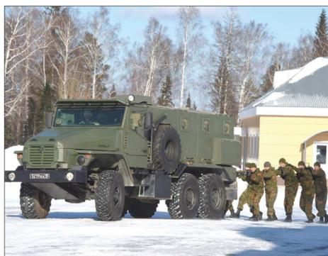
Бронемашина «Урал-ВВ» защищает бойцов спецназа от пуль, осколков, а также от мин и самодельных взрывных устройств
