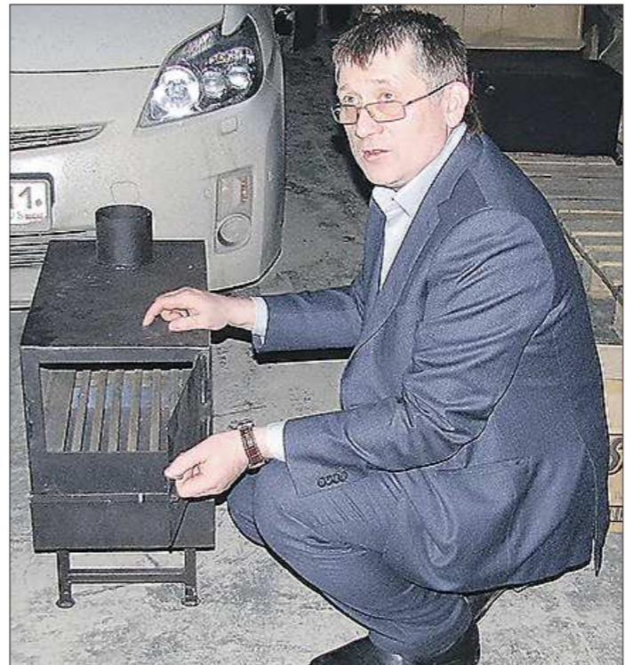
Дмитрий Вершинин показывает буржуйку для Луганска. Она хоть и проста на вид, но сделана с колосниками и поддувалом, значит, не только дрова будут в ней хорошо гореть, но и украинский уголь. А если обложить такую буржуйку кирпичом, то и тепло будет храниться дольше
