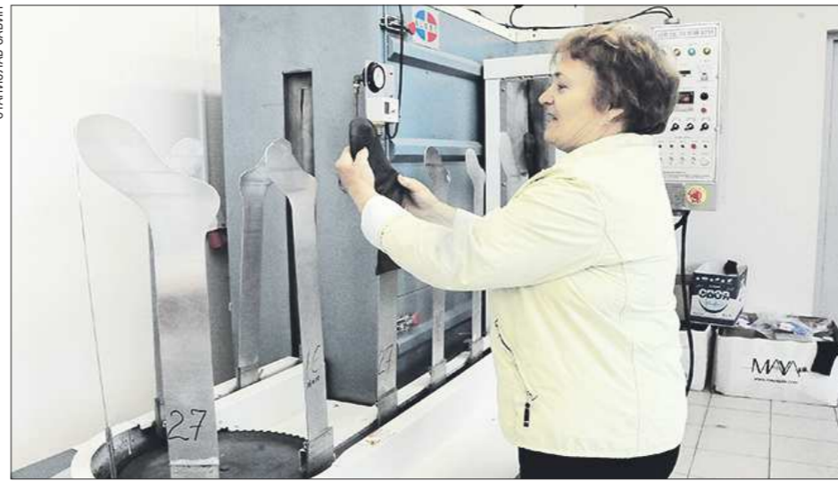
В швейном цехе работает формовочная машина — своеобразный паровой утюг, придающий изделиям форму, которую мы привыкли видеть на прилавках
