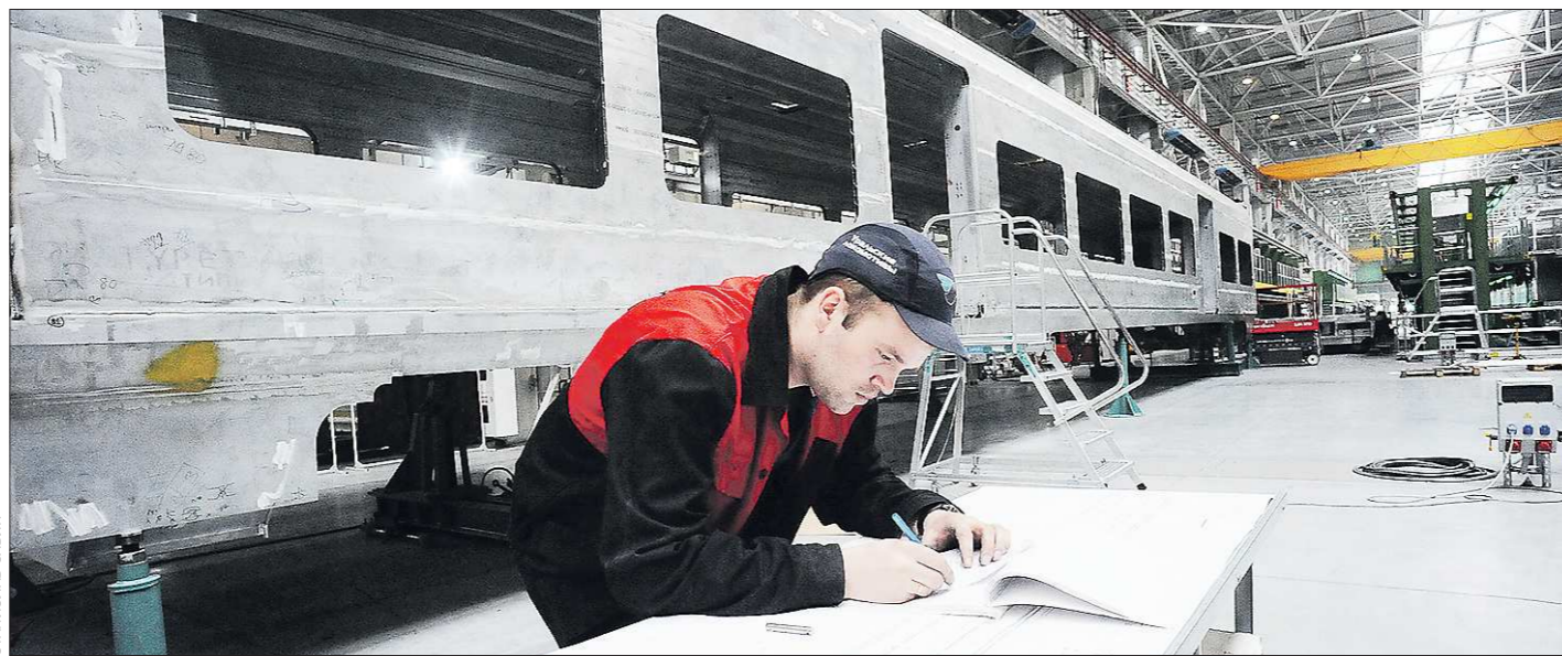
Современные пассажирские электропоезда в Верхней Пышме производятся по технологии алюминиевой сварки, которая никогда прежде не применялась на предприятиях Свердловской области
