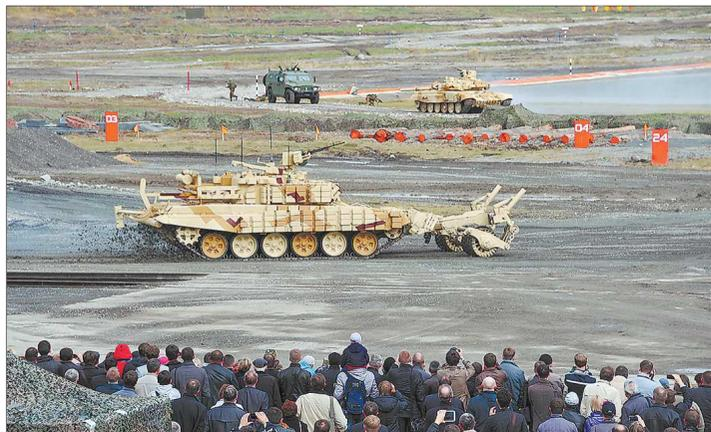
Бронированная машина разминирования в действии
