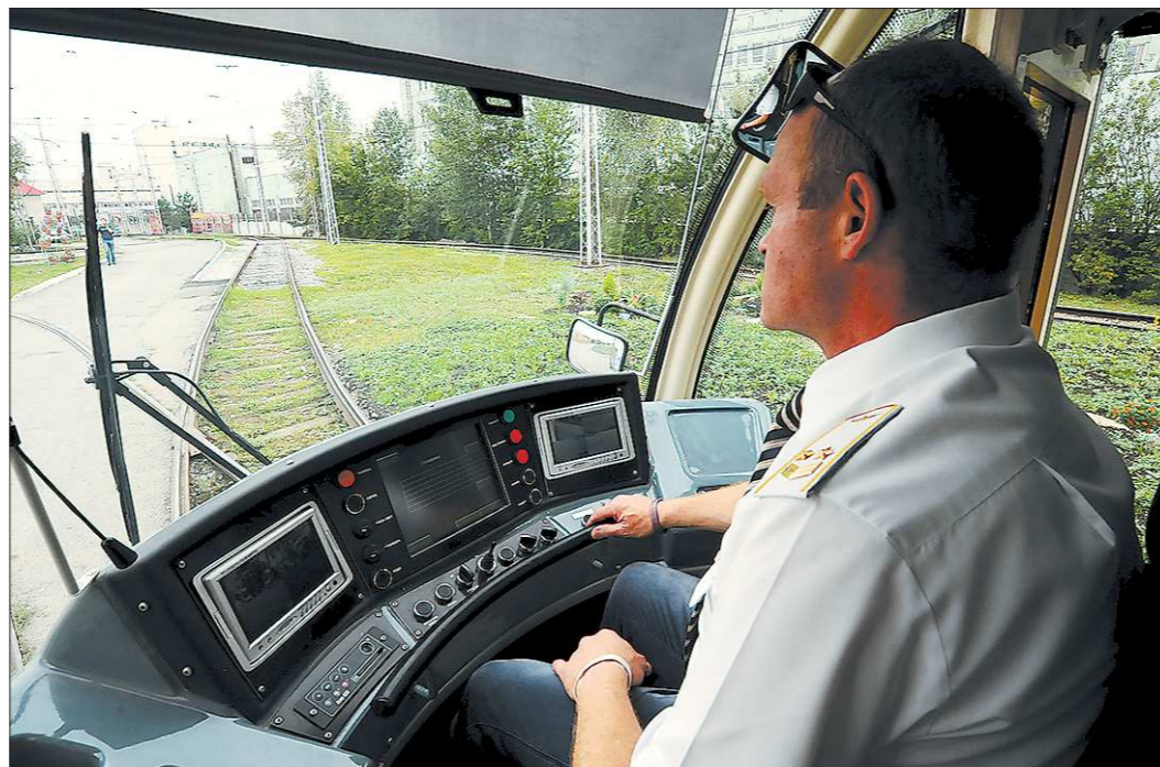
Модель 71-409 — единственная российская разработка полностью низкопольного трамвая, высота пола от уровня рельсов составляет в нём всего 350 миллиметров
