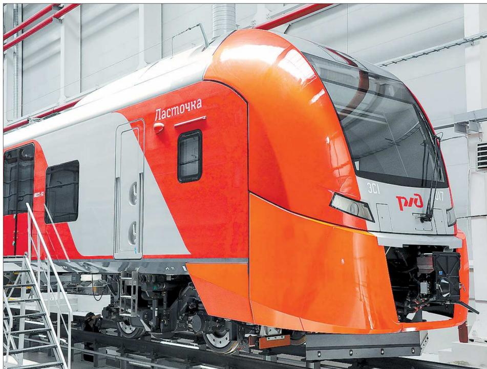
В минувшую субботу на заводе «Уральские локомотивы» (СП Группы Синара и концерна «Сименс АГ») в Верхней Пышме стартовало производство скоростных электропоездов нового поколения «Ласточка». В кузовном цехе нового производственного комплекса предприятия произведена сварка первого 25-метрового кузова электропоезда из экструдированного алюминия. Так внешне будет выглядеть уральская «Ласточка»
