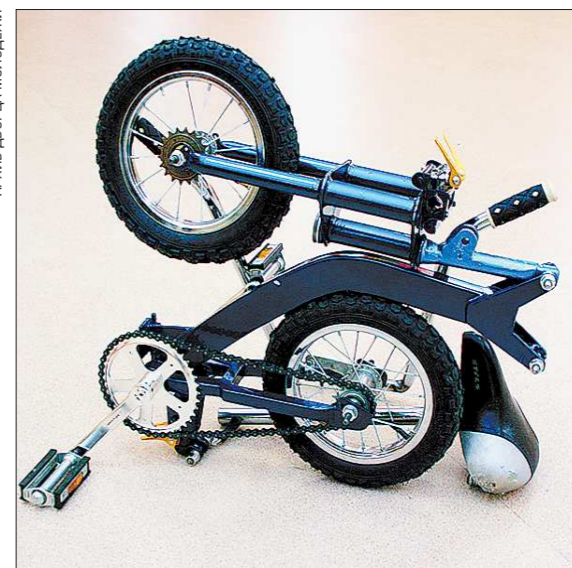
В сложенном виде велосипед имеет размеры 60 на 60 сантиметров и весит всего семь килограммов
