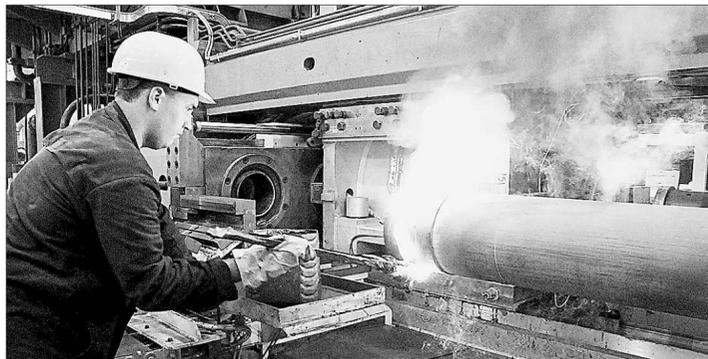
На Каменск-Уральском заводе по обработке цветных металлов осваивают новые технологии производства прутков из сплавов меди
