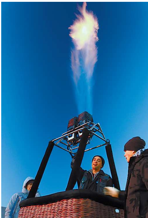
Так, горелкой, спортсмены нагревают воздух в оболочке шара – процесс сопровождается характерным шумом.
