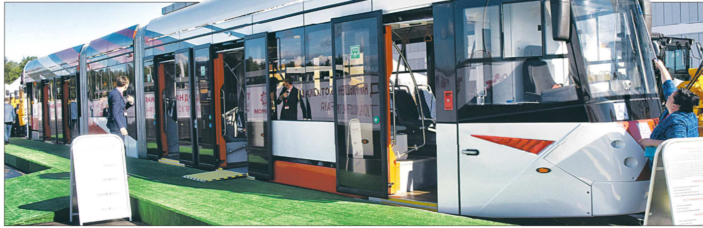
Уралтрансмаш представил на выставке низкопольный трёхсекционный вагон 71-418, предназначенный для людей с ограниченными возможностями здоровья и пассажиров с детьми
