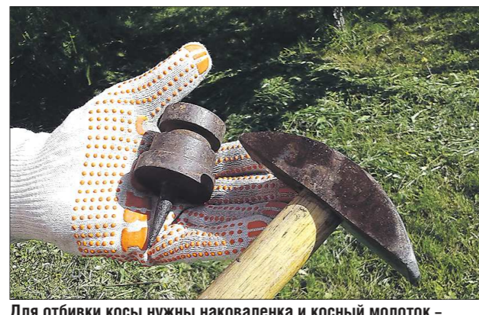
Для отбивки косы нужны наковаленка и косный молоток – такие приспособления встретишь сегодня редко
