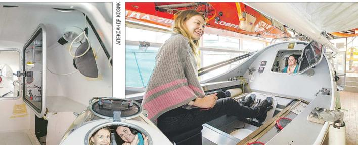
Кокпит на «Акросе» по сравнению с «Тургойяком» (на фото) уменьшен. Это сделано, чтобы снизить риски для гребца быть смытым большой волной. За счёт этого на новой лодке на полметра увеличен кормовой отсек, теперь он имеет три водонепроницаемые переборки
