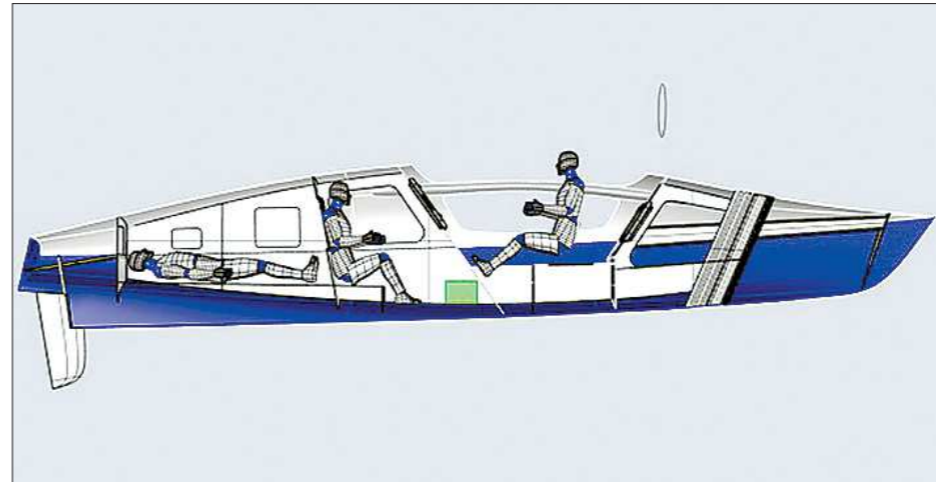
Размер лодки, на которой Фёдор Конохов отправится в кругосветку – 9 метров. Носовая часть разделена на два водонепроницаемых отсека, там будут храниться продукты на 300 дней и оборудование. В корме находится навигационная рубка, камбуз, далее отдельный отсек для отдыха
