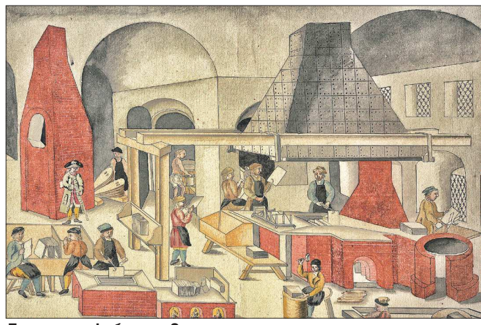
Лудильная фабрика. «Содержать квасы в однодонных кадках... и в оные кадлы для квашения чёрную жель, чтобы она была чиста и железны на ней не было. По отбиранию печь, насыпая угля, разжечь огнём. (...) И как распотлила, то взьяв жести в клещи листов 80, спустить в котёл олово... потихоньку» – так этот процесс описывал сам Вильгельм де Геннин
