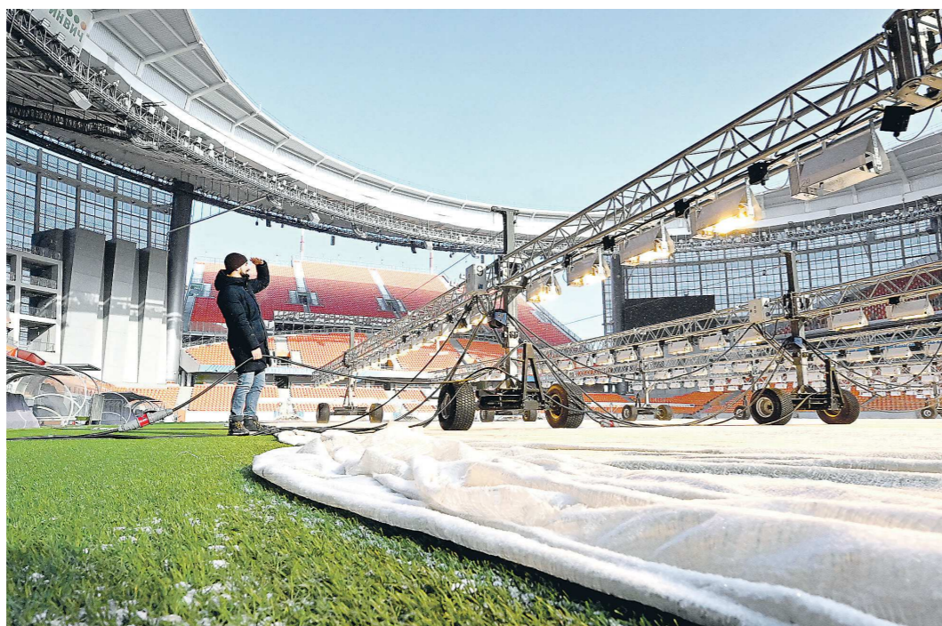
Агрономы «Екатеринбург Арены» в ежедневном режиме следят за состоянием поля. Одна из главных задач – освещение газона, которое происходит с помощью 540 ламп
