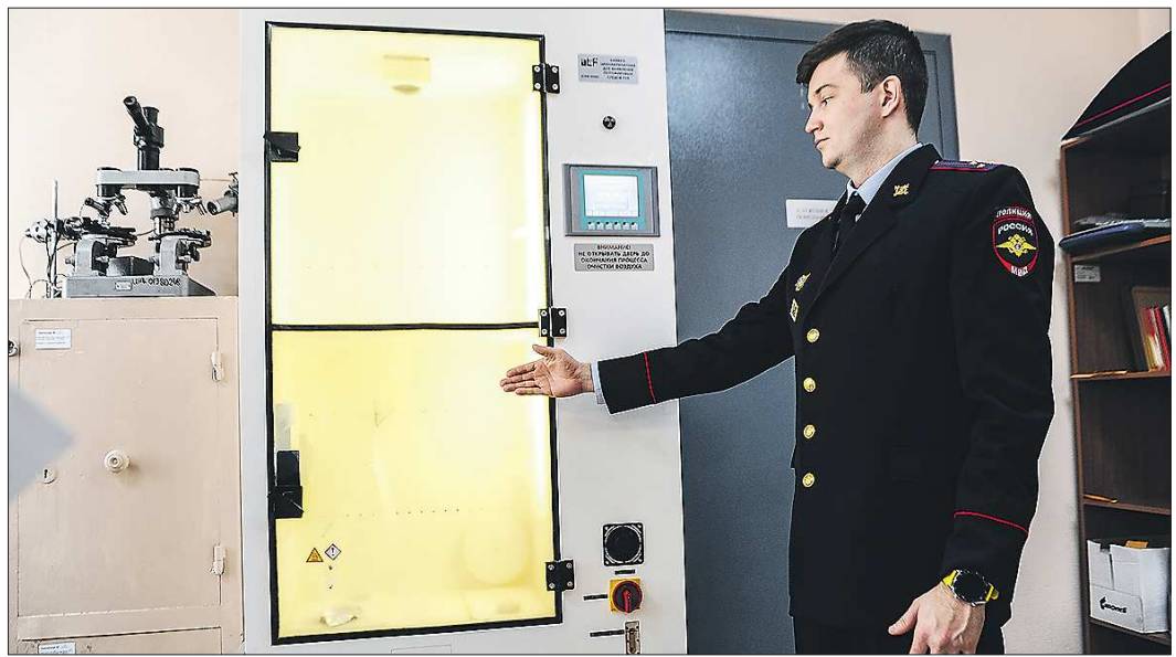
Эксперт-криминалист Игорь Менжулин демонстрирует цианакрилатную камеру
