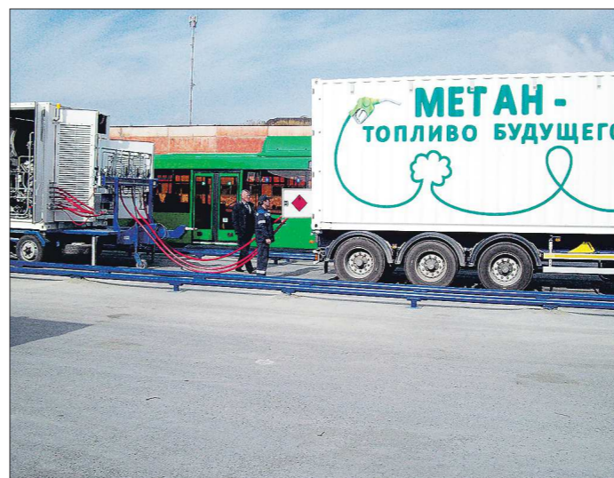
Передвижной газозаправщик «Титан-4» вмещает в себя 10 тысяч кубометров природного газа
