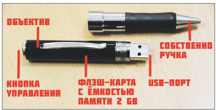
Заординарной внешностью ручки-«толстухи» прячется скрытая камера
